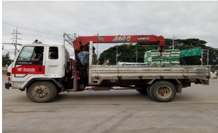
ภาพ 4.3 รถบรรทุก 6 ล้อติดเครน
